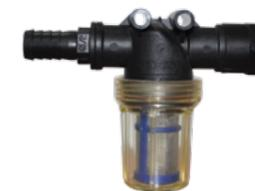
Диаметр 20. Вход G 3/4"М, выход G 3/4"Ф. Фильтрующая способность 55 л/мин. Макс. давление 10 бар. Корпус и стаканчик из полипропилена с повышенной прочностью, стаканчик прозрачный. Комплект картриджа фильтра из нержавеющей стали (голубой), фильтрующая способность 298 микрон.
