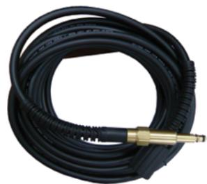
Шланг ВД 22x1,5/d 8,8 одноплеточный из пластмассы диаметром 6 мм. Выдерживает давление 160 бар и температуру 60°C. Подходит к аппаратам Karcher, длина 10 м.
