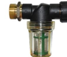
Вход G 1"М, выход G 1"Ф. Макс. давление 10 бар. Корпус и стаканчик из полипропилена с повышенной прочностью, стаканчик прозрачный. Комплект картриджа фильтра из нержавеющей стали, фильтрующая способность 149 микрон.
