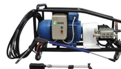
**В состав АВД входит:** защитный металлический каркас, двигатель, помпа GKC 16/50 S-L (UDOR, Италия), регулятор давления, вентиль тепловой защиты, манометр, фильтр тонкой очистки, шланг высокого давления 15 м, пистолет с копьём 800 мм, форсунка 030 (500 бар), плечевая опора.
