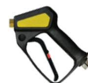
Профессиональный универсальный пистолет высокого давления ST-2300. Эргономичная рукоятка, сбалансированный угол наклона. Вход 22x1,5 П. Выход 1/4 М. Максимум: 310 бар, 45 л/мин, 150°C.
