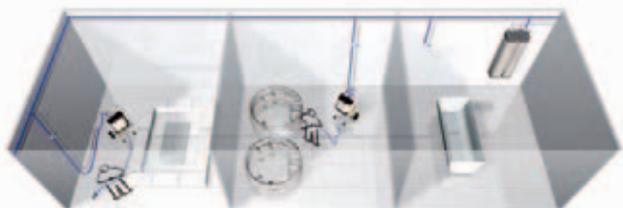
Данная система позволяет каждому пользователю индивидуально выбирать моющие и дезинфицирующие препараты. Каждый моющий пост имеет подводку воды под давлением от насосной / главной станции и сжатого воздуха от компрессора предприятия, сателлитная станция снабжена собственными моющим и дезинфицирующим препаратами. Все виды оборудования оснащены функциями: мойка, нанесение пены и дезинфекция.
